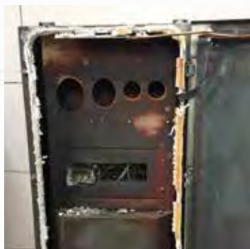
Fotodokumentation von Brandversuchen mit swibox Elektranten
