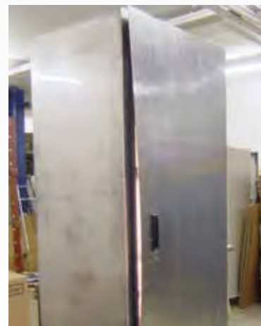
Statische Druckfestigkeitsprüfung mit einem Standardschrank IP65 versprengt bei 2.7 kPa
