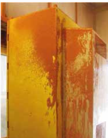
Prüfung Schutzart IP65 nach abgeschlossener dynamischer Druckfestigkeitsprüfung
