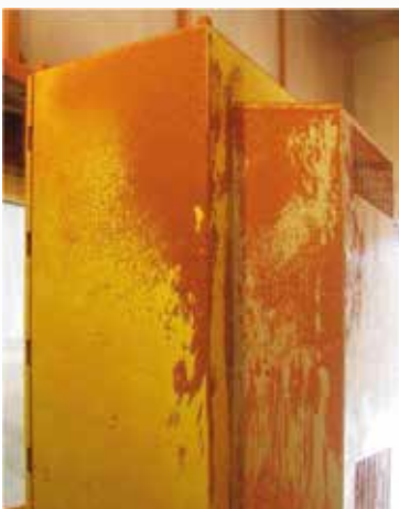
Prüfung Schutzart IP65 nach abgeschlossener dynamischer Druckfestigkeitsprüfung
